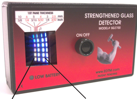
Figure 1: Contrôle d'une fenêtre à double vitrage à l'aide du SG2700. Veuillez remarquer qu'une colonne de réflexion apparaît pour chaque surface de verre.
