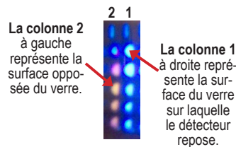
Figure 2: Réflexion d'un vitrage simple dans la fenêtre de visualisation
